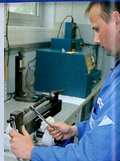
Eine Spezialvorrichtung erleichtert die beschädigungsfreie Demontage (oben). Anschließend folgt eine Sichtprüfung der filigranen Bauteile.
