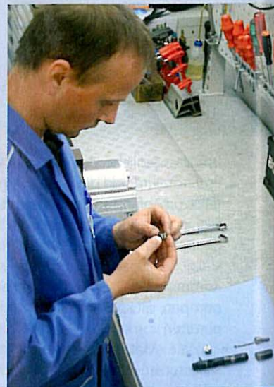
Eine Spezialvorrichtung erleichtert die beschädigungsfreie Demontage (oben). Anschließend folgt eine Sichtprüfung der filigranen Bauteile.
