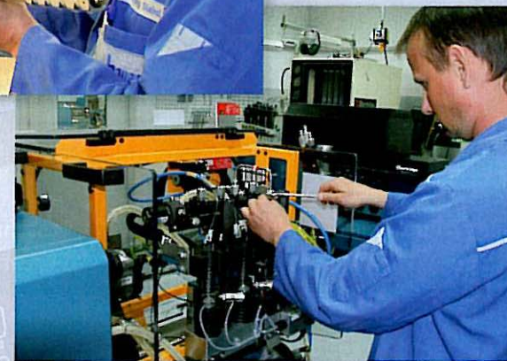
Aufgespannt: Nach der Instandsetzung müssen die Injektoren auf dem PC-gesteuerten Hartridge-Prüfstand in einem ausführlichen Testlauf ihre Leistungsfähigkeit beweisen.
