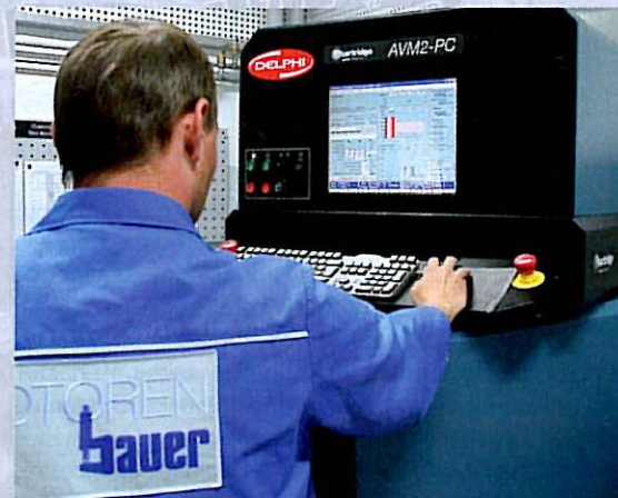
Abschlussprüfung: Nach einem umfangreichen Leistungstest vergibt die Delphi-Software für den instandgesetzten Injektor einen neuen C2I-Code. Injektoren anderer Hersteller prüft Motoren Bauer mit einer Universalsoftware.
